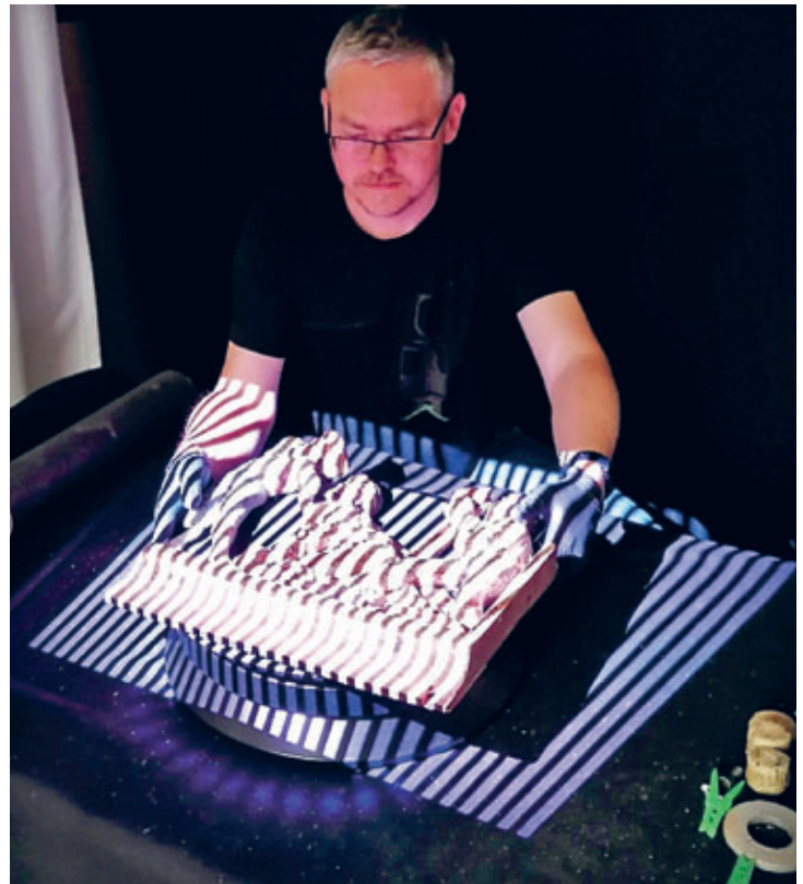
Herr Reuter, Landesamt für Archäologie Sachsen justiert ein Original für den Streifenlichtscanner, © Walter
